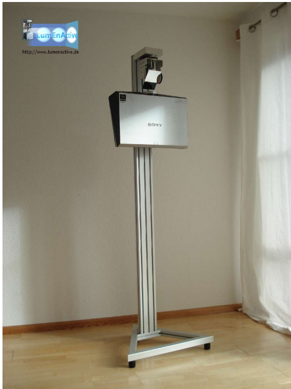
Abbildung 1: LumEnActive: Projektor und Reflexionseinheit montiert auf Profilschiene
